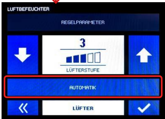
Fig. 5.5.2: Setting the fan speed
